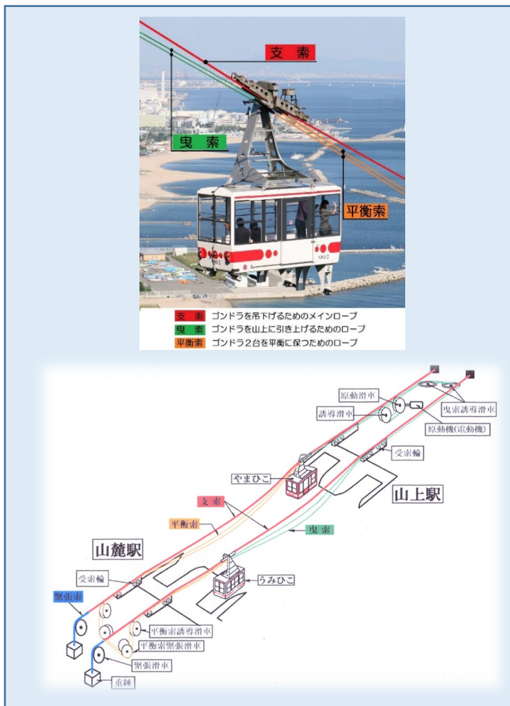
ロープウェイの仕組み
