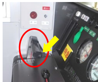
ハンドルに設置したデッドマン装置
