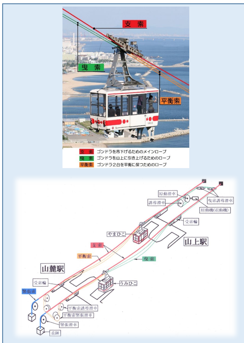
ロープウェイの仕組み
