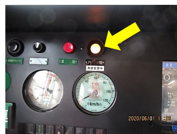
運転台の戸閉表示灯
