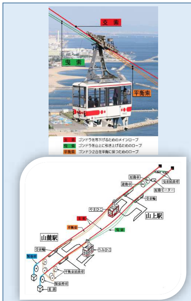
ロープウェイの仕組み
