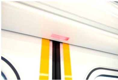
開閉予告ランプ
