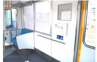
車いすスペース
