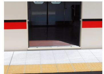
段差を解消した江井ヶ島駅
