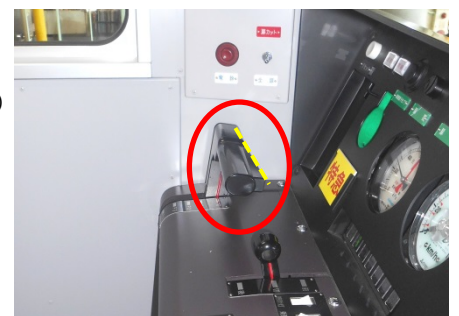
ハンドルに設置したデッドマン装置
