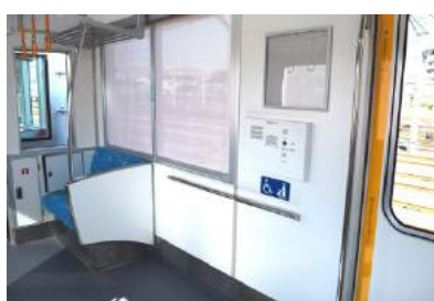
車いすスペース
