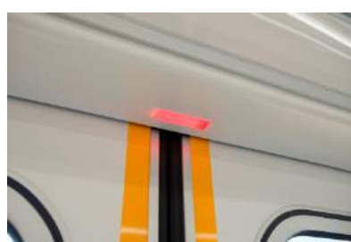
開閉予告ランプ
