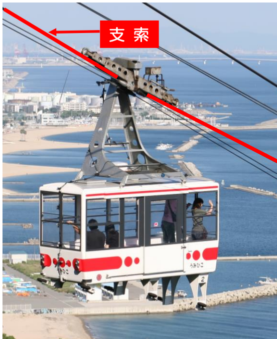
支索(ゴンドラを吊り下げるためのメインロープ)
