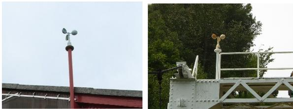
ロープウェイ・運転室上の風速計 観光リフト・両国橋の風速計
